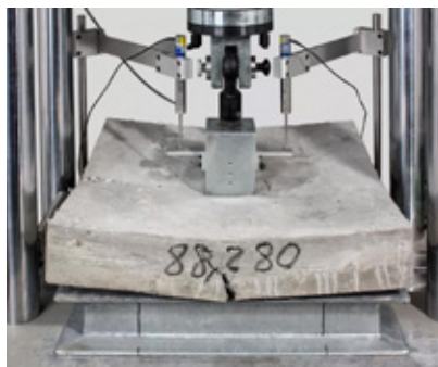
Ensaio em painel quadrado: EN 14488-5
