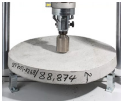
Ensaio em painel circular: ASTM C1550
